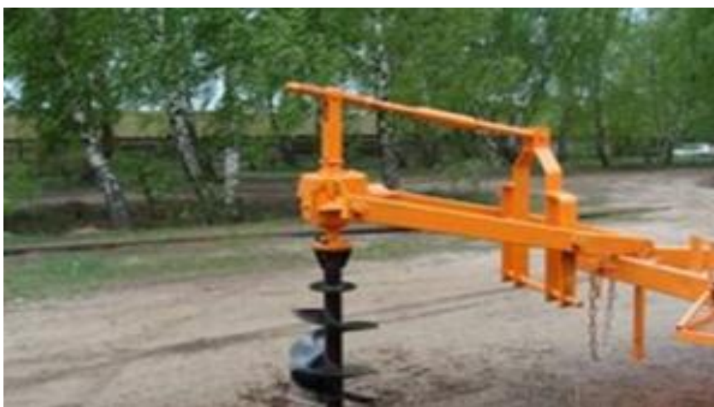
Рис. 3 – Навесной тракторный бур
