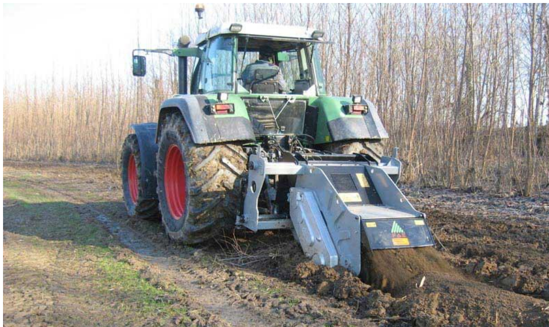
Рис. 2 – Сужение лесной полосы посредством удаления крайних рядов
