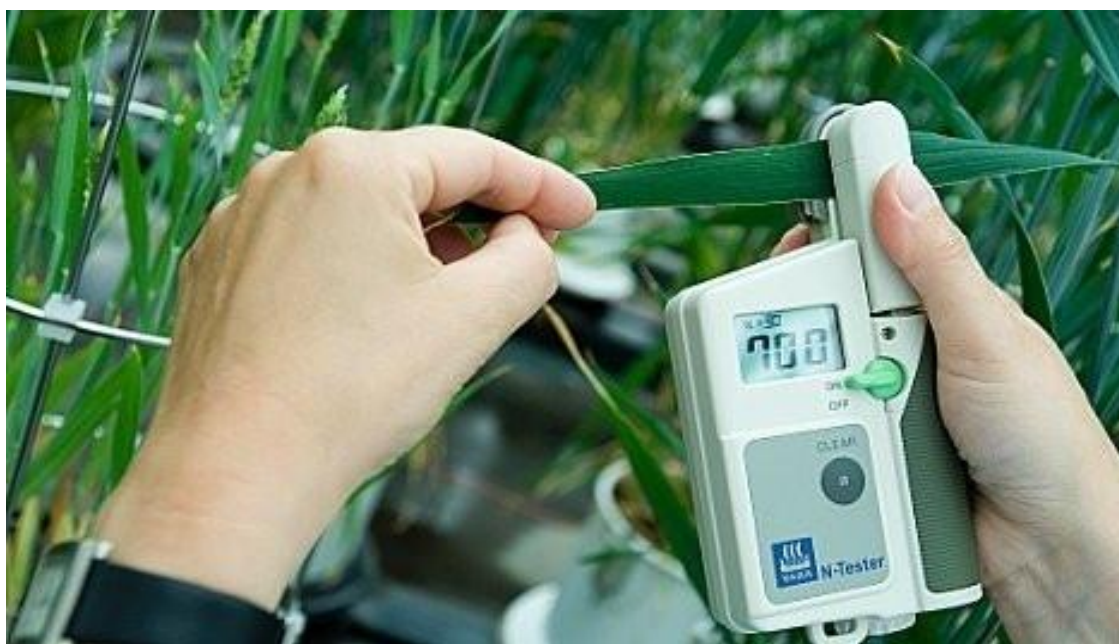
Рис. - Определение необходимости проведения азотных подкормок на качество зерна с использованием «N-тестера».
